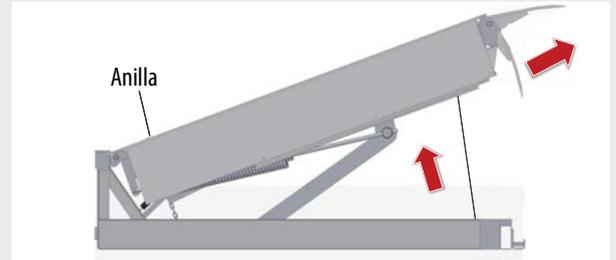
2. Tiramos de la anilla y mantenemos la tensión para liberar el freno y permitir que la rampa se eleve hasta la máxima posición y abra el labio.
