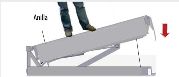
5. Una vez finalizado el proceso de carga y/o descarga, procederemos al cerrado de la rampa. Volvemos a tirar de la anilla hasta una altura media, sin llegar al máximo, y nos subimos de nuevo a la plataforma de la rampa para hacerla descender.
