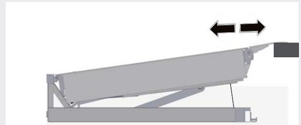
4. Una vez apoyada la rampa en el camión, este es el momento para iniciar el proceso de carga y/o descarga de mercancías con el tránsito de carretillas.
