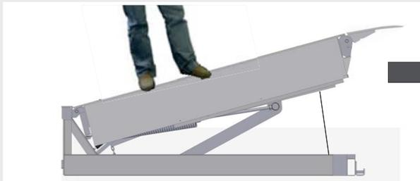
3. Una vez la rampa ha llegado a su máxima elevación, caminaremos encima de ésta para hacer descender suavemente la rampa y que ésta se apoye en la caja del camión.
