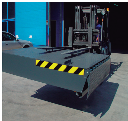
Las piezas de manipulación están ideadas para mover la rampa en cualquier sentido.
