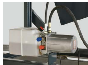
Centralita hidráulica de la RH11
